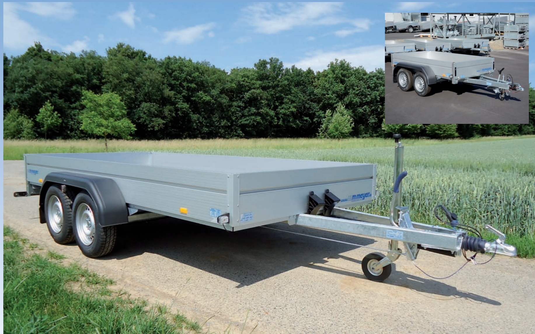
BT 2740/185 Stützrad verstärkt, klappbar, mittig; kleines Bild: BT 2030/151 Zubehör: Stirnwand klappbar BT 2740/185 Roue jockey renforcée, automatique, au milieu ; petite image : BT 2030/151 Option : ridelle avant ouvrable BT 2740/185 Reinforced jockey wheel, automatic, in the middle; small picture: BT 2030/151 Optional: front panel which can be opened
