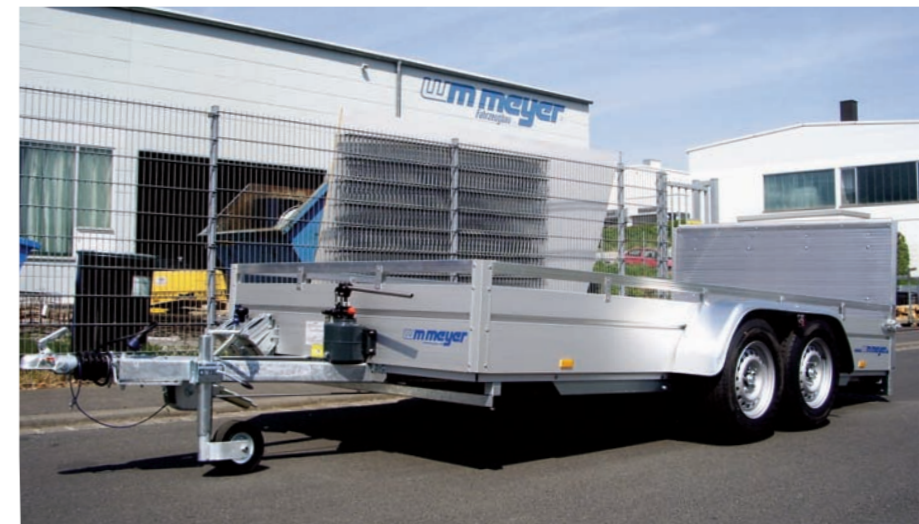
Spezialanhänger, hier: Senkliftanhänger BTSL Zubehör: Reling Remorques spéciales, ici : remorques surbaissantes BTSL Option : main-courante Special trailer, here: elevating trailer BTSL Optional extra: top rail
