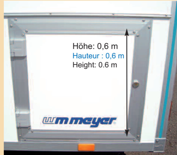
Gasflaschenschrank (2 x 11 kg) Pièce pour bouteilles de gaz (2 x 11 kg) Compartment for gas bottles (2 x 11 kg)
