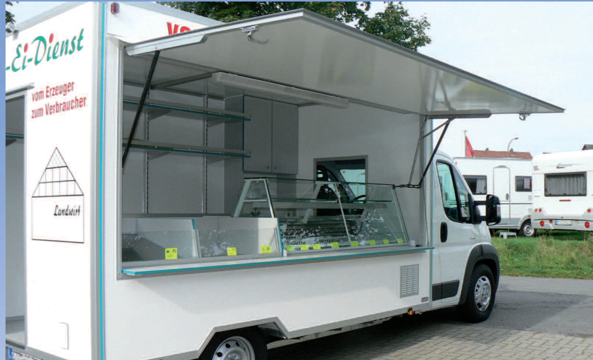
VMA 500 Verkaufsmobil aufbau mit Tiefrahmenfahrgestell, Kühltheke und Durchgangstür zur Fahrerkabine VMA 500 Véhicule de vente avec châssis bas, vitrine frigorifique et porte entre carrosserie et cabine du chauffeur VMA 500 Vending van with low chassis, cooler cabinet and door between box und driver's cabin
