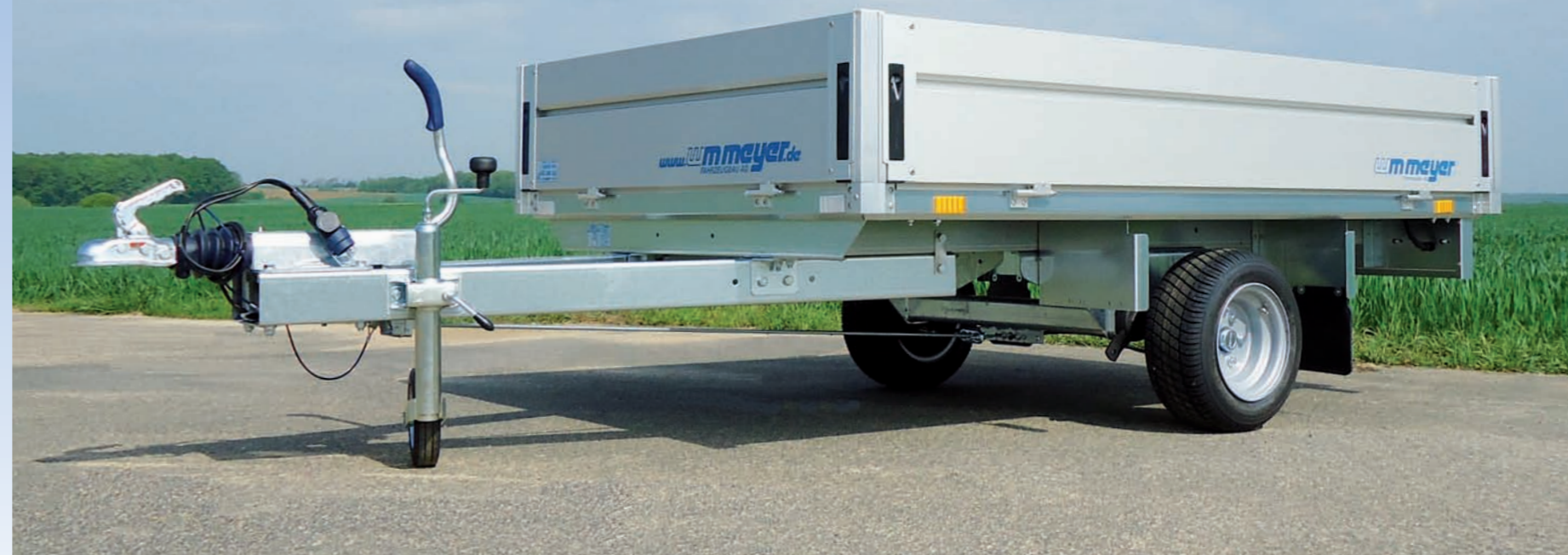
HLN 1323/141 Achse, Rahmen und V-Deichsel verzinkt, Verschlüsse innenliegend; kleines Bild: Zubehör: Flachplane HLN 1323/141 Essieu, châssis et timon en V galvanisés, serrures intégrées aux ridelles ; petite image : bâche basse HLN 1323/141 Galvanised axle, chassis and V drawbar, fastenings integrated into side panels; small picture: low canvas top
