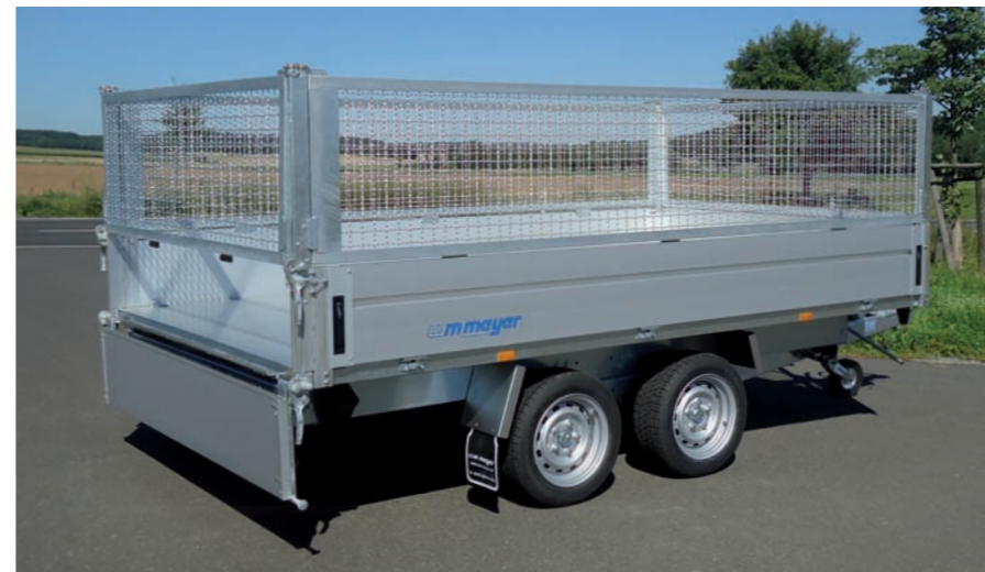
HKCR 2731/186 Zubehör: E-Pumpe, Gitteraufsatz HKCR 2731/186 Opt. : pompe électrique, rehausse HKCR 2731/186 Opt.: electric pump, mesh extens.
