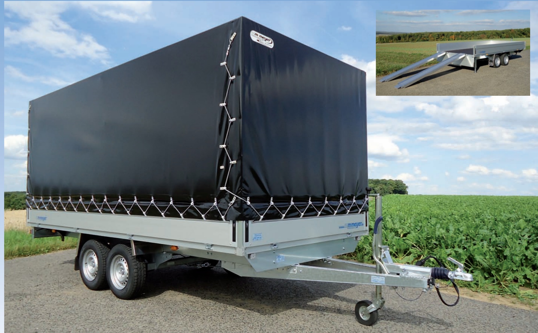
HLC 2746/210 Zubehör: Plane und Aluminiumspriegel; kleines Bild: HLC 2741/186 Zubehör: Auffahrschienen, Klappkurbelstützen HLC 2746/210 Options : bâche et ossature en alu ; petite image : HLC 2741/186 Options : rampes en alu, béquilles avec manivelle HLC 2746/210 Optional: canvas top, aluminium support; small picture: HLC 2741/186 Optional: loading ramps, prop stands with crank
