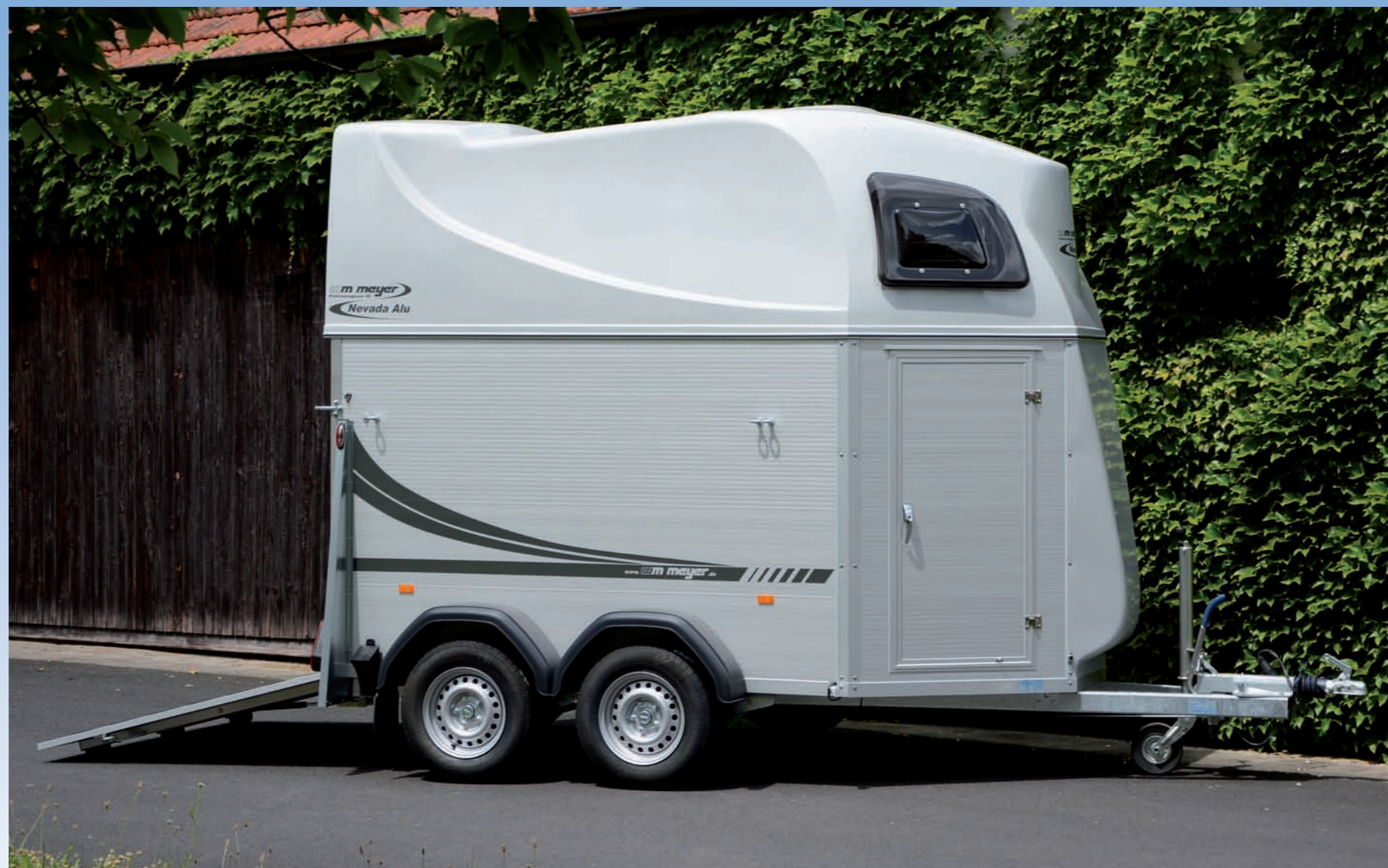
Stützrad verstärkt (klappbar), Aluminiumwände Roue jockey renforcée (automatique), panneaux en aluminium Reinforced jockey wheel (automatic), aluminium side panels
