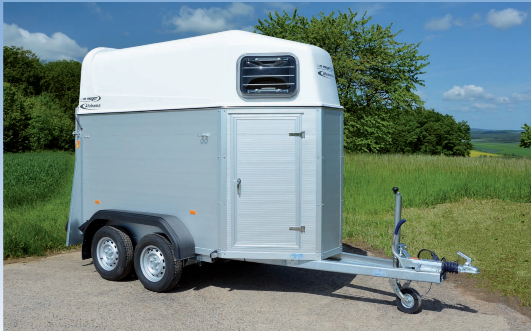
Stützrad verstärkt (klappbar, mittig), 2 Kunststoffkotflügel, Aluminiumwände Roue jockey renforcée (automatique, au milieu), 2 garde-boues en plastique, panneaux en aluminium Reinforced jockey wheel (automatic, in the middle of the drawbar), 2 plastic mudguards, aluminium side panels
