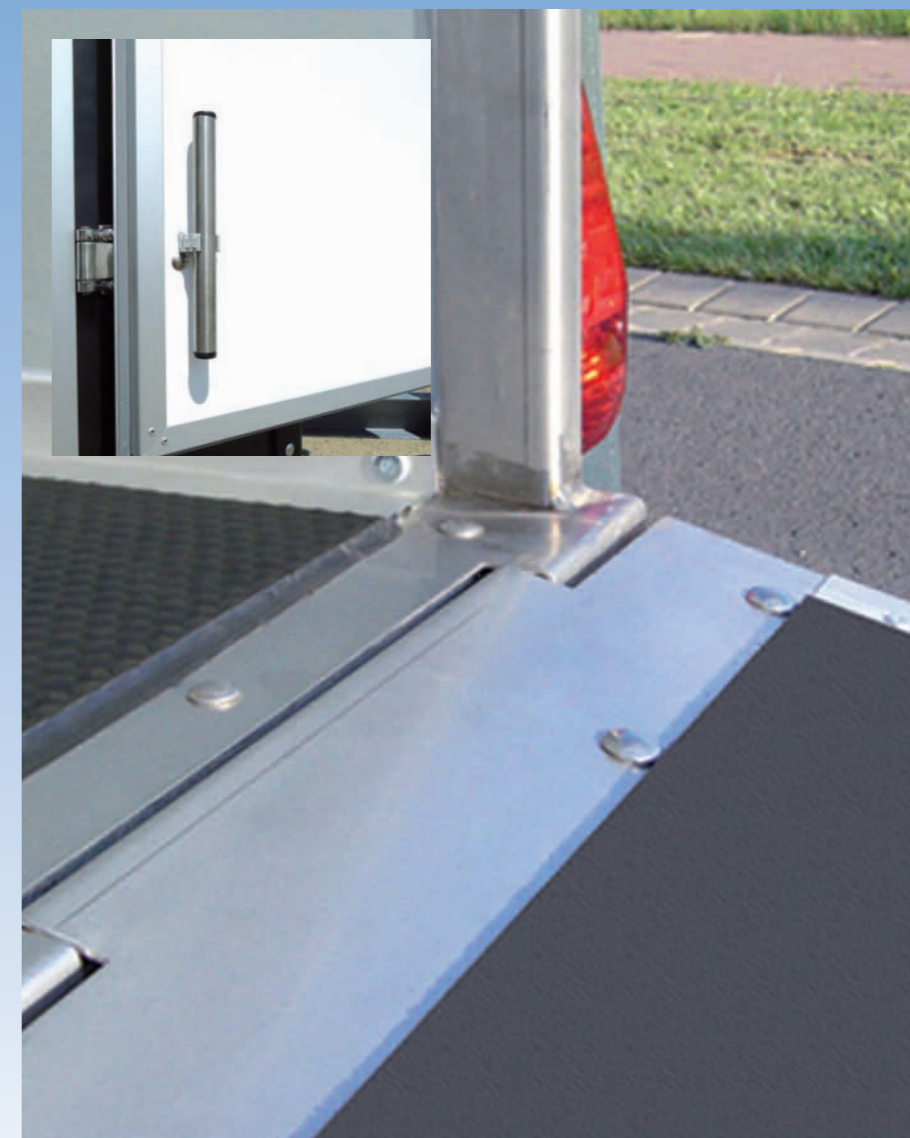
Klappenscharnier, Heckrahmen und -träger aus Edelstahl (V2A), Profile aus Aluminium; kleines Bild: Boxenstangenentriegelungsstange Charnière, bâti arrière et supports en inox, profilés en aluminium ; petite image : mécanisme d'ouverture d'urgence pour barres de poitrail Stainless-steel hinge, rear frame and supports, aluminium profiles; small picture: safety opening mechanism for breast bars
