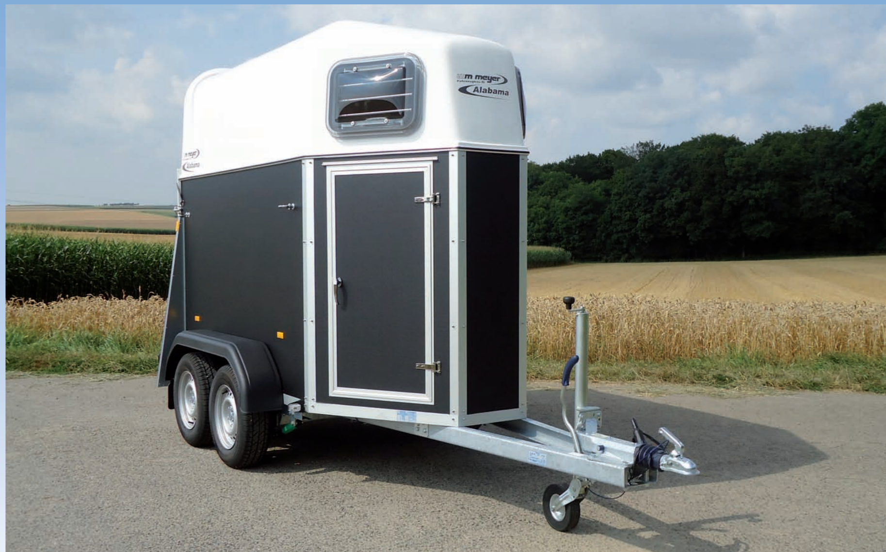
Kunststoffbeschichtete Holzwände (außen: schwarz, innen: weiß), Stützrad verstärkt (klappbar, mittig) Panneaux en bois recouverts en plastique (extérieur : noir, intérieur : blanc), roue jockey renforcée (automatique, au milieu) Wooden side panels with protective layers (exterior: black, interior: white), reinforced jockey wheel (automatic, in the middle of the drawbar)
