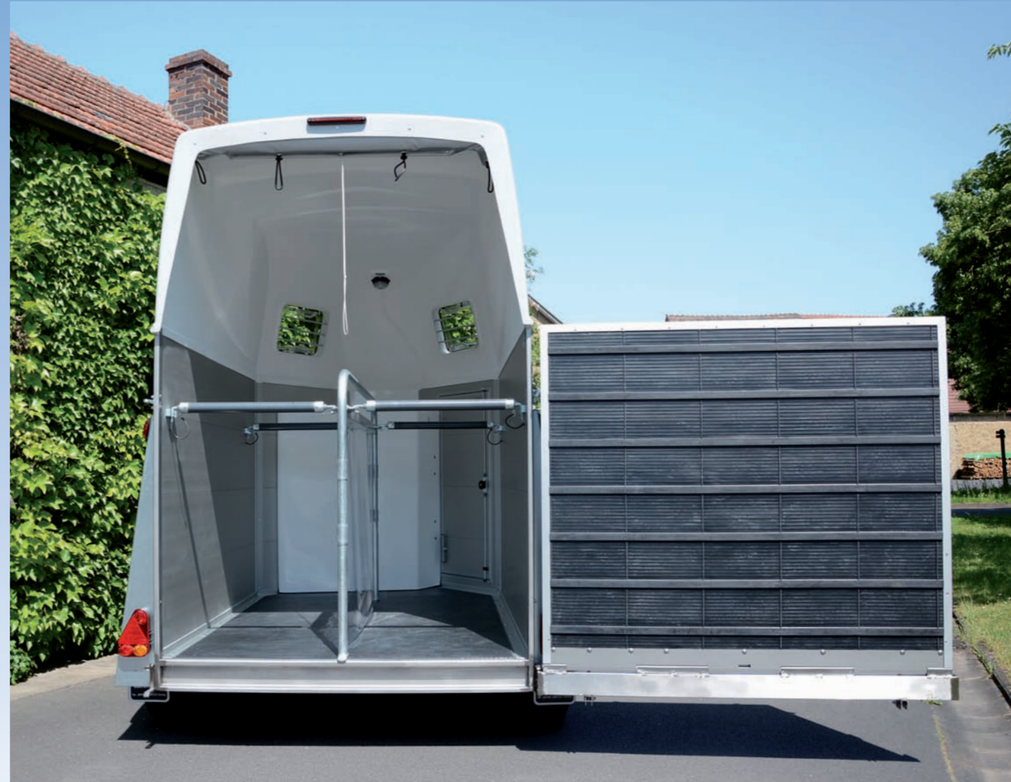
Kombination Rampe und Tür; Gummimatte (Antiverschleiß); Schaufel und Besen (Kunststoff) mit Halter (in Sattelkammer) Combinaison pont et porte ; tapis anti-usure ; pelle à capot et balayette en plastique avec support (dans sellerie) Combination ramp and door; anti-wear mat; dustpan and brush made of plastic with support (in saddle chamber)
