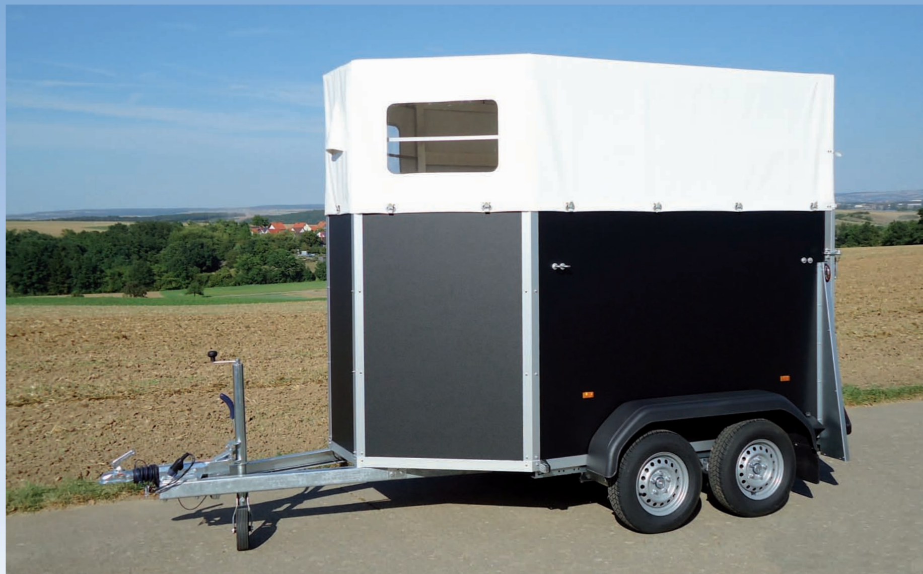
Plane (weiß) und Aluspriegel (Höhe: 750 mm), kunststoffbeschichtete Holzwände (außen: schwarz, innen: weiß) Bâche (blanc) et ossature en aluminium (hauteur : 750 mm), panneaux en bois recouverts en plastique (extérieur : noir, intérieur : blanc) Canvas top (white) and aluminium support (height: 750 mm), wooden side panels with protective layers (exterior: black, interior: white)
