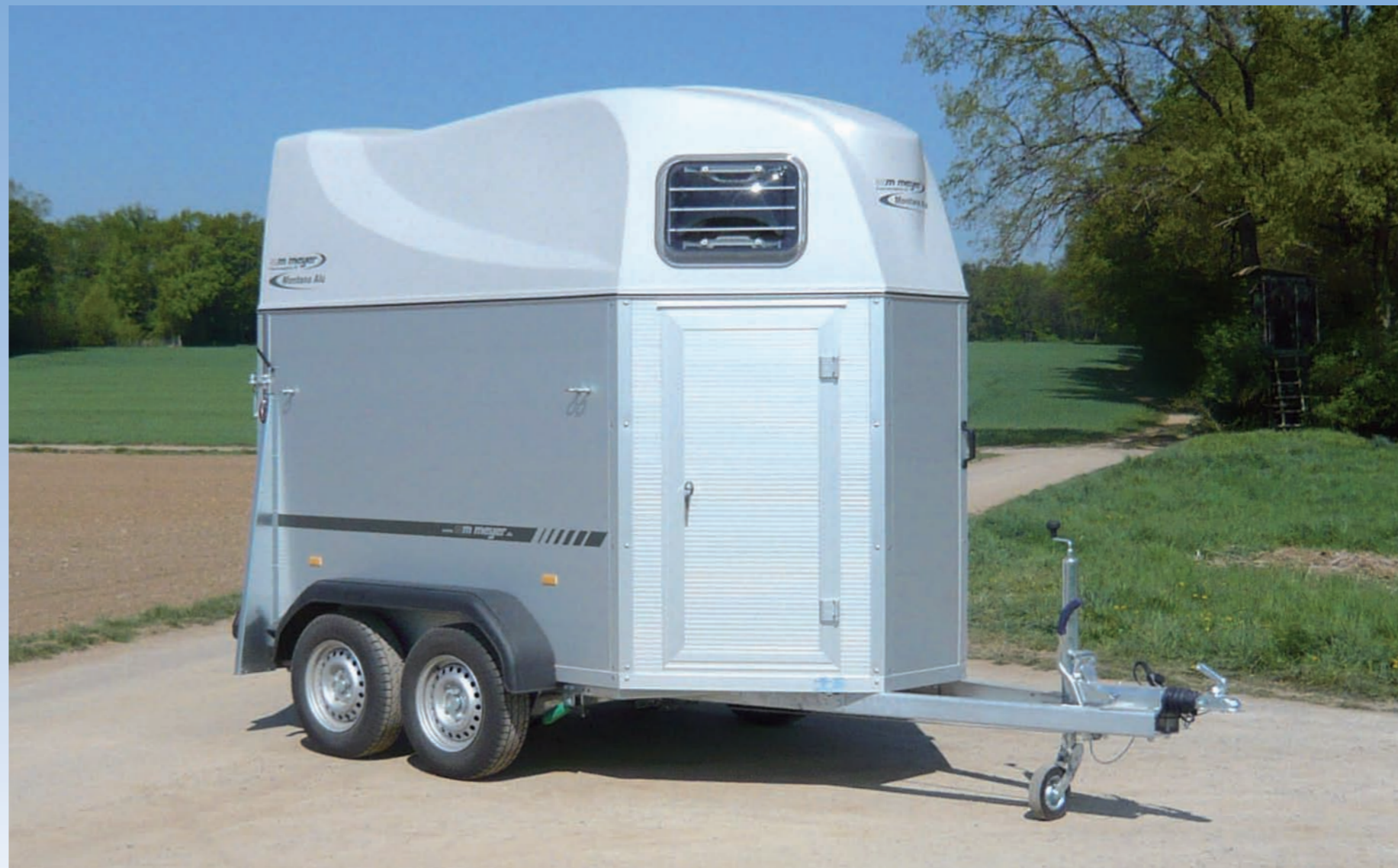
Serienmäßig: 4 Radstoßdämpfer, Stützrad verstärkt (klappbar, mittig) En série : 4 amortisseurs, roue jockey renforcée (automatique, au milieu) Standard features: 4 shock absorbers, reinforced jockey wheel (automatic, in the middle of the drawbar)
