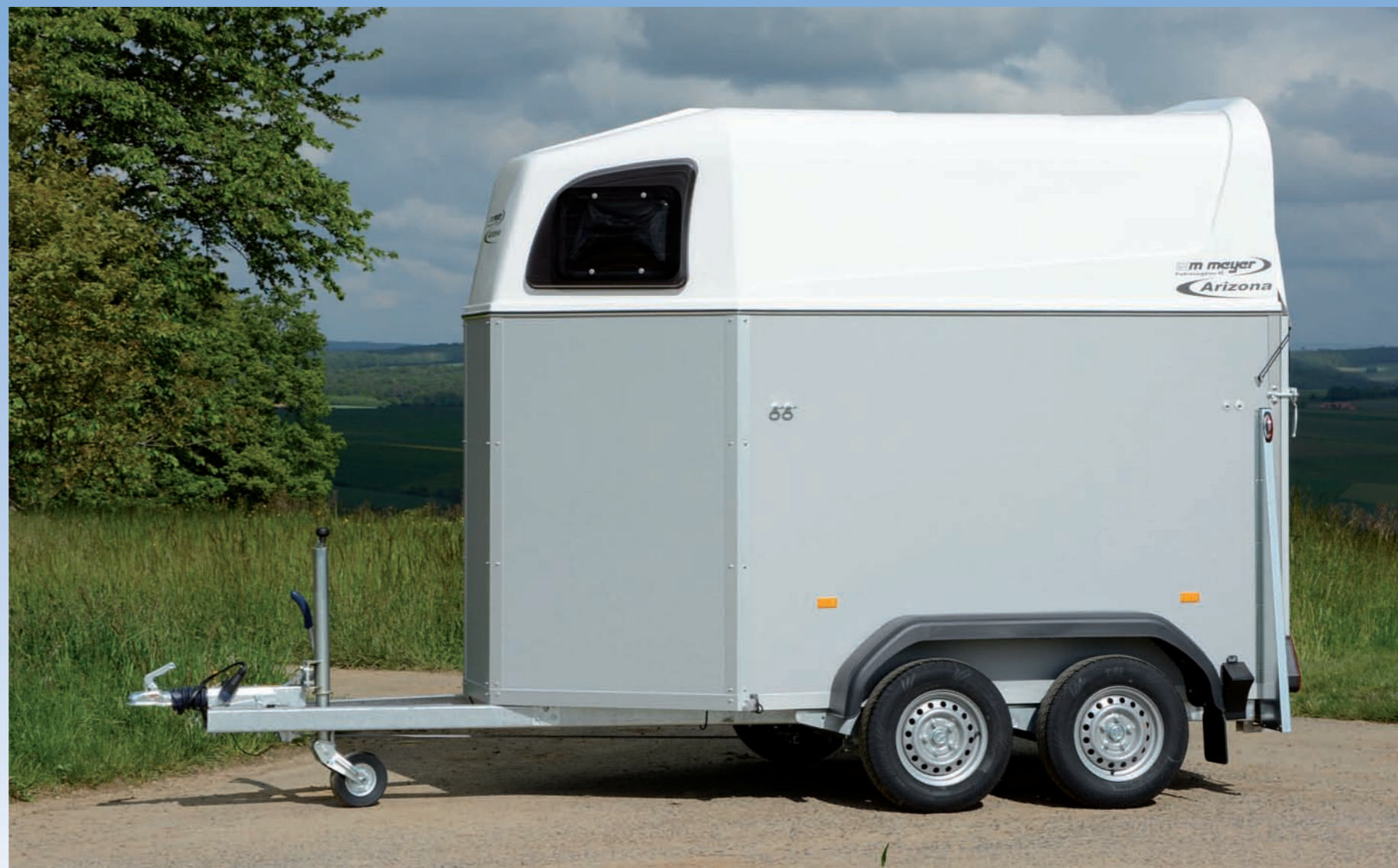
Serienmäßig: Stützrad verstärkt (klappbar), kunststoffbeschichtete Holzwände (außen: silber, innen: weiß) En série : roue jockey renforcée (automatique), panneaux en bois recouverts de plastique (extérieur : argent, intérieur : blanc) Standard features: reinforced jockey wheel (automatic), wooden side panels with protective layers (exterior: silver, interior: white)
