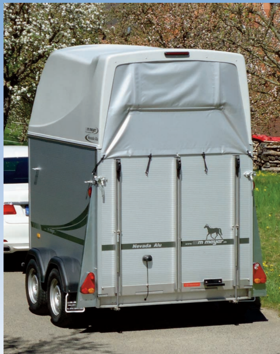
Klappenscharnier, Heckrahmen und -träger aus Edelstahl (V2A), Profile aus Aluminium; kleines Bild: Boxenstangenentriegelungsstange Charnière, bâti arrière et supports en inox, profilés en aluminium ; petite image : mécanisme d'ouverture d'urgence pour barres de poitrail Stainless-steel hinge, rear frame and supports, aluminium profiles; small picture: safety opening mechanism for breast bars
