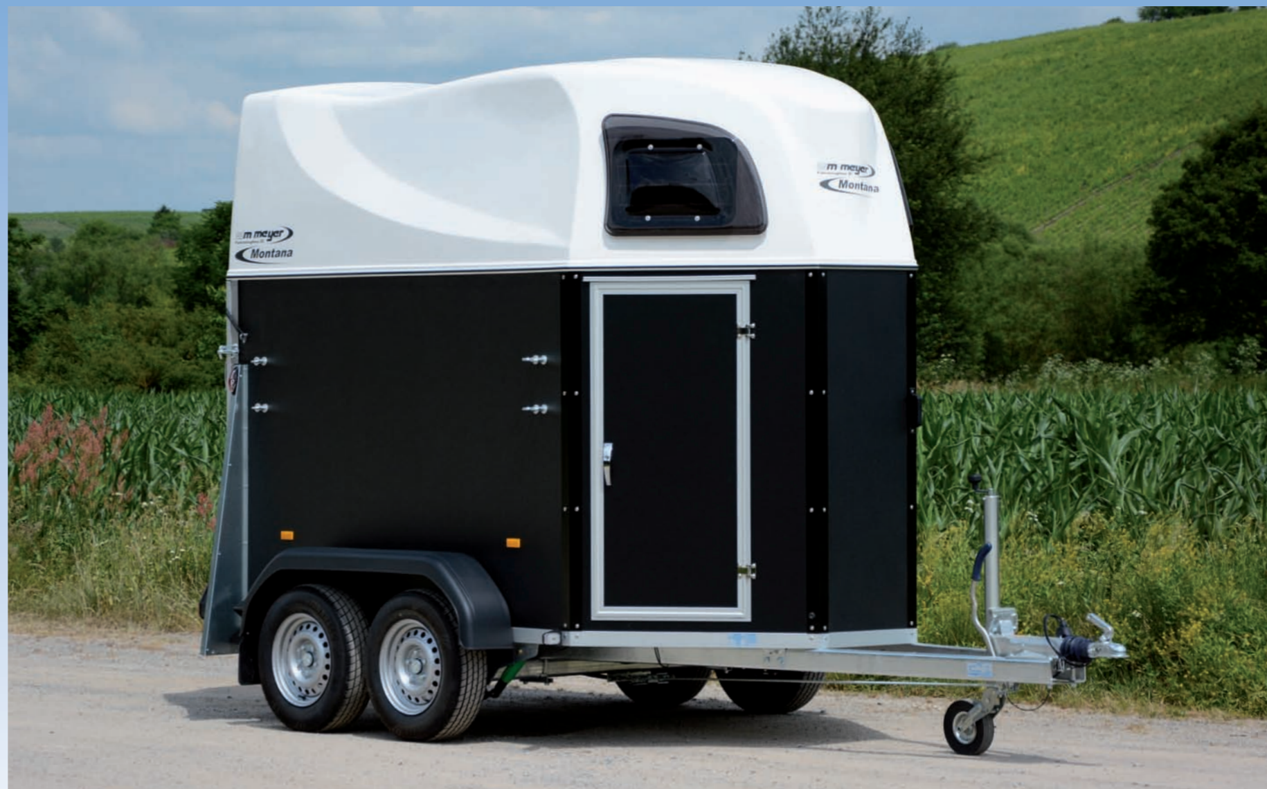
Holzwände (außen: schwarz, innen: weiß), Polyesterhaube, Innenlänge: 3.050 mm, Innenhöhe: 2.340 mm Panneaux en bois (extérieur : noir, intérieur : blanc), hardtop en polyester, longueur intérieure : 3.050 mm, hauteur intérieure : 2.340 mm Wooden side panels (exterior: black, interior: white), polyester hardtop, internal length: 3,050 mm, internal height: 2,340 mm
