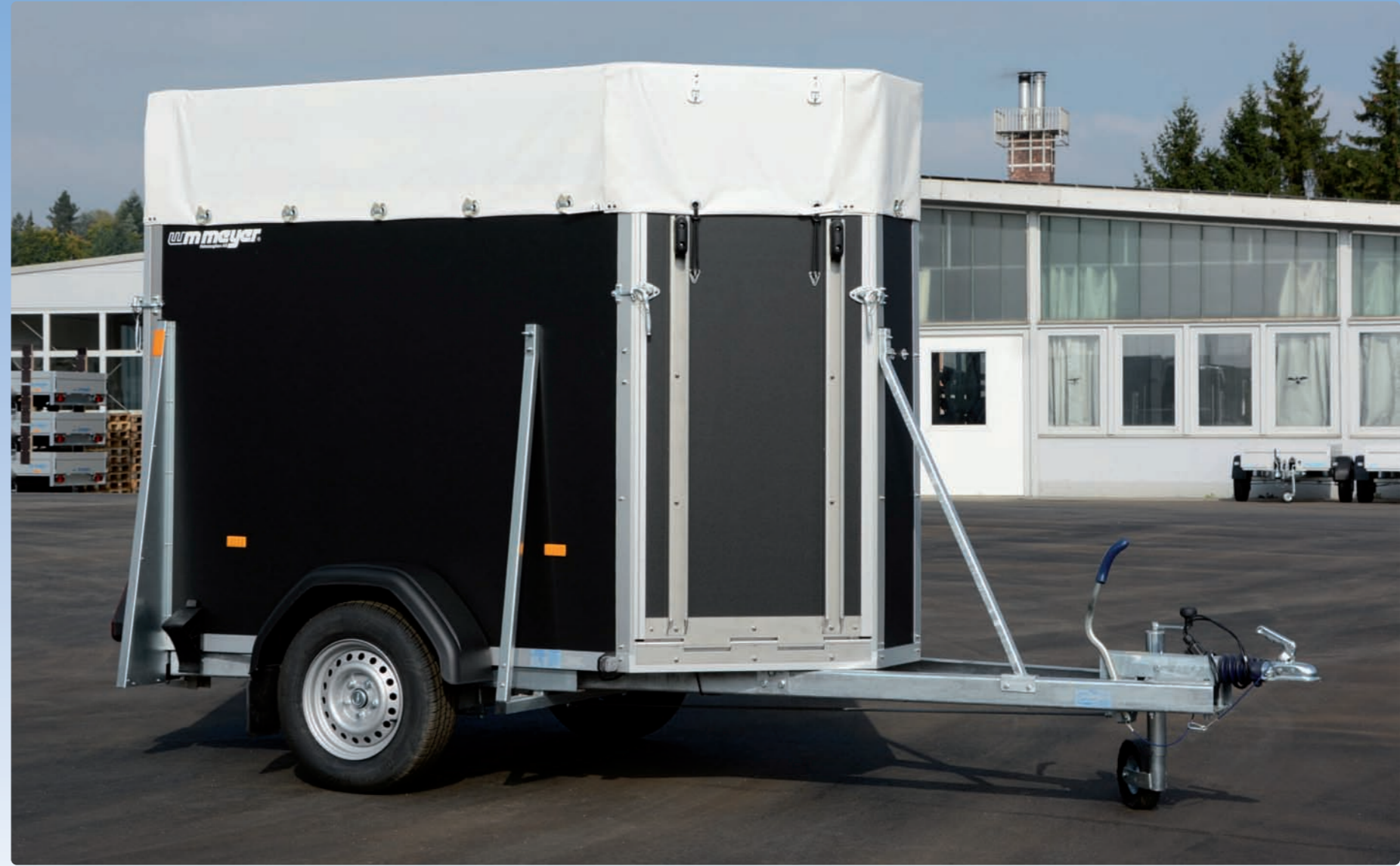
V 1325/129 Achse, Rahmen und V-Deichsel verzinkt, Zubehör: Frontausstieg, Hochplane und Aluspriegel (Höhe: 350 mm) V 1325/129 Essieu, châssis et timon en V galvanisés, options : pont avant, bâche haute et ossature en alu (hauteur : 350 mm) V 1325/129 Galvanised axle, chassis and V drawbar, optional extras: front exit, high canvas top and aluminium support (height: 350 mm)
