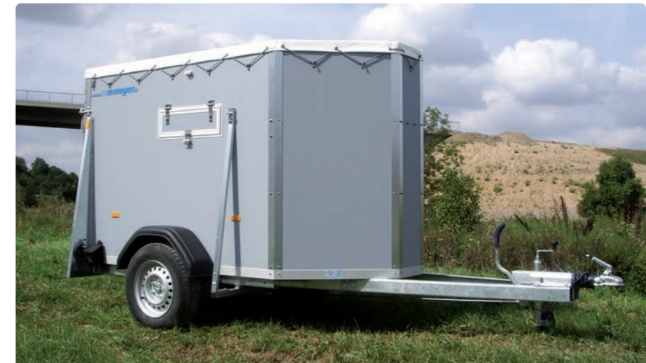
V 1325/129 Spitz, Zubehör: Lüftungsklappe, Flachplane V 1325/129 Panneau avant pointu, options : clapet d'aération, bâche basse V 1325/129 V-shaped front panel, optional extras: ventilation hatch, low canvas top
