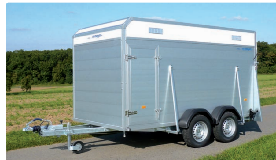
V 2535/179 Vollaluminiumanhänger, Zubehör: u. a. Isodach in Sandwichpolyester V 2535/179 Remorque tout aluminium, options : toit isolé en polyester, etc. V 2535/179 All-aluminium trailer, optional extras: sandwich polyester roof, etc.
