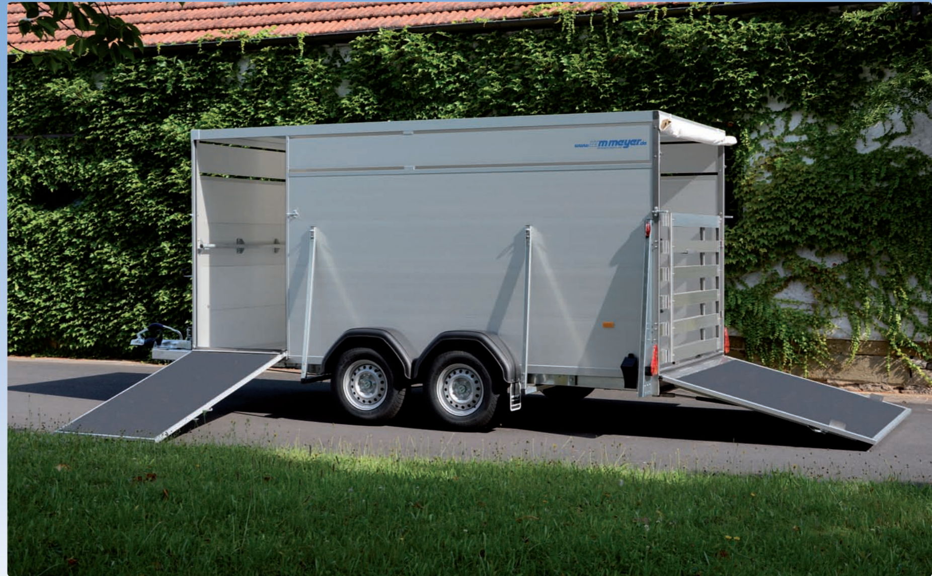
Frontausstieg, Treibgitter aus Aluminium, Anbindestange, Dach in Aluminium und Sandwichpolyester Pont avant, barrières d'encadrement (en aluminium), barre d'attache, toit iso en aluminium et polyester sandwich Front exit, aluminium ramp gates, tie-down bar, iso roof made of aluminium and sandwich polyester
