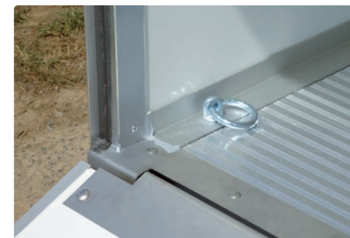
Befestigungspunkt (Stahl verzinkt) Point d'arrimage (acier galvanisé) Tie-down points (galvanised steel)
