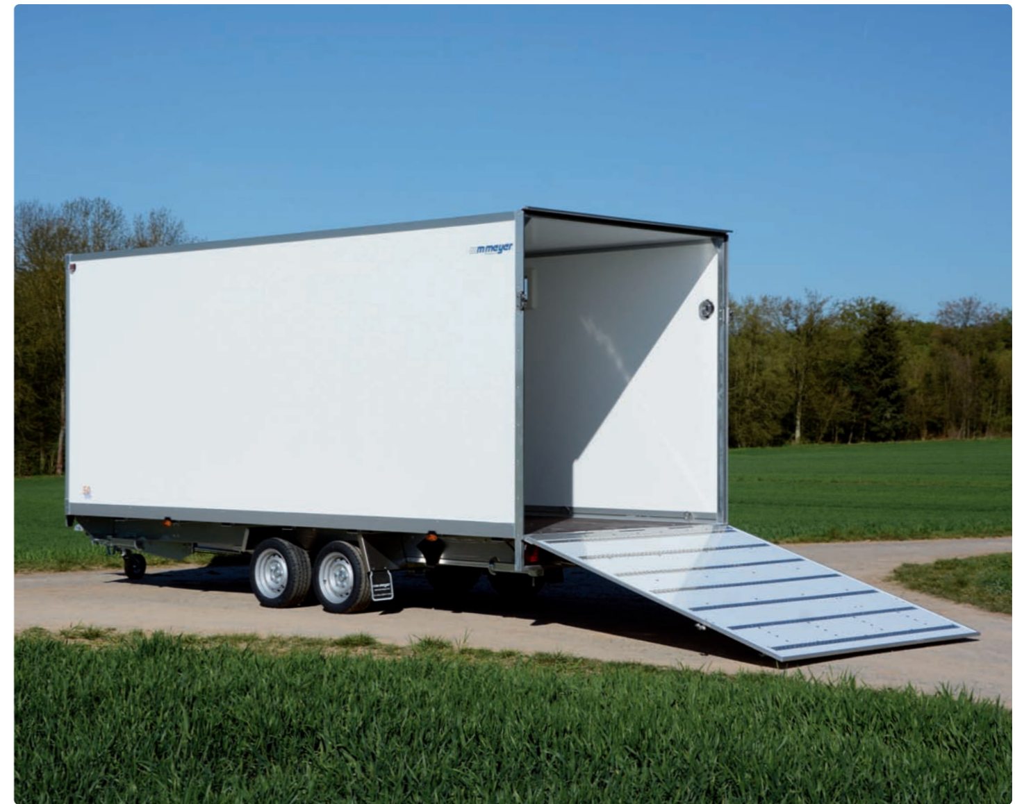
AZHLC 2750/210 Zubehör: u. a. Klappkurbelstützen, Heckrampe mit Hebedämpfern AZHLC 2750/210 Options : béquilles à relever avec manivelle, pont arrière avec amortisseurs, etc. AZHLC 2750/210 Optional extras: prop stands to be folded away, with crank, ramp with shock absorbers, etc.
