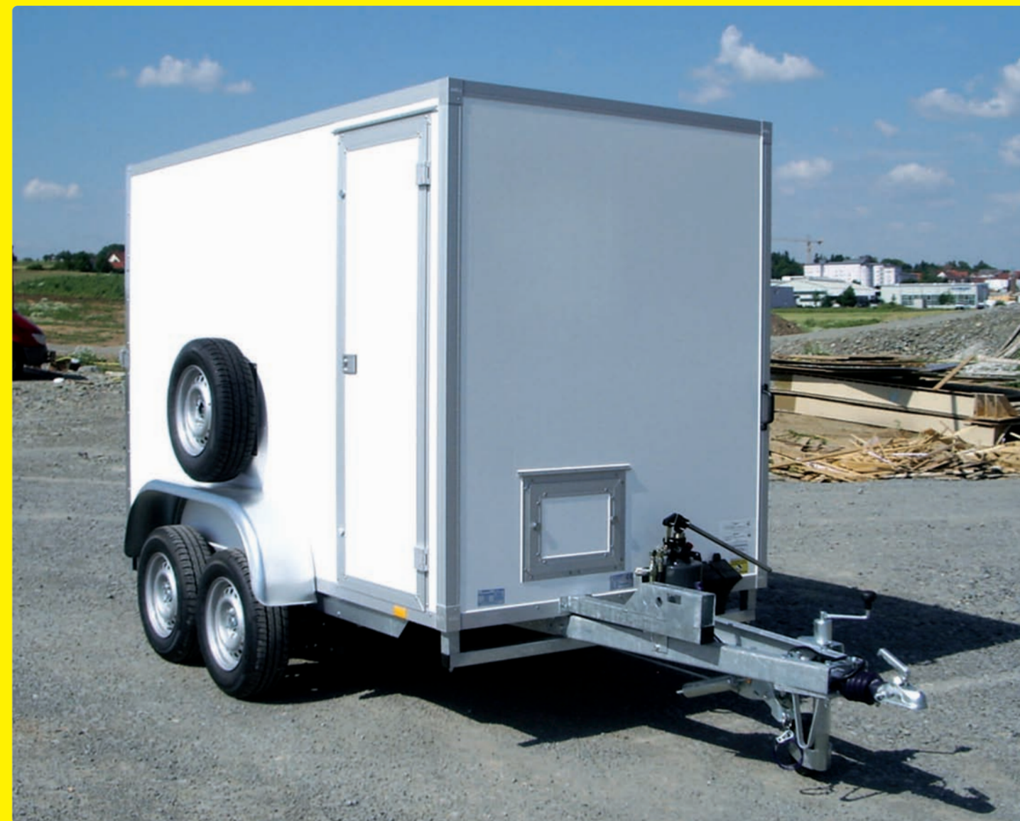
AZSL 2730/151 Serie 40 Zubehör: Windenbock, Klappe in Stirnwand für Seildurchführung, Seitentür, Ersatzrad mit Halter AZSL 2730/151 Série 40 Options : support de treuil, porte avant pour câble de treuil, porte latérale, roue de secours avec support AZSL 2730/151 Series 40 Optional extras: winch support, cable door integrated into front panel, side door, spare wheel with support
