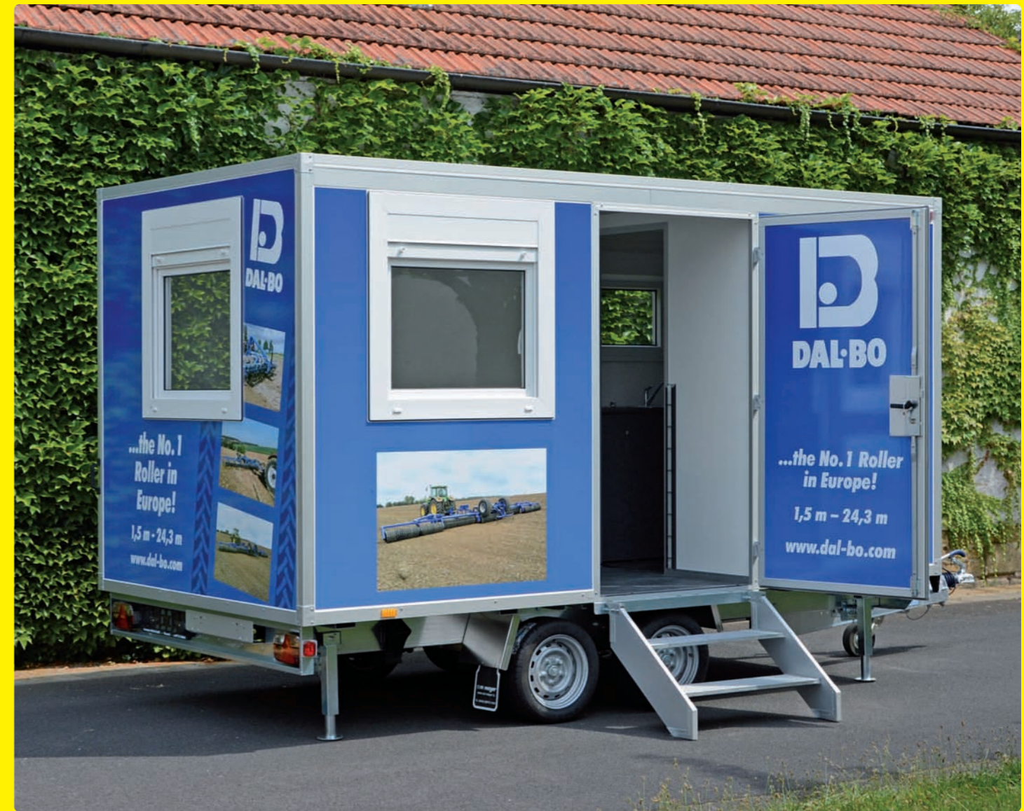
AZHLC 2740/210 Sonder Serie 40 Zubehör: u. a. Treppe, Seitentür, Fenster mit Rolläden, Innenausbau, Werbeklebung AZHLC 2740/210 Spéciale Série 40 Options : escalier, porte latérale, fenêtres, volets roulants, équipements intérieurs, publicité, etc. AZHLC 2740/210 Special Series 40 Optional: steps, side door, windows with rolling shutters, interior fittings, advertising stickers, etc.
